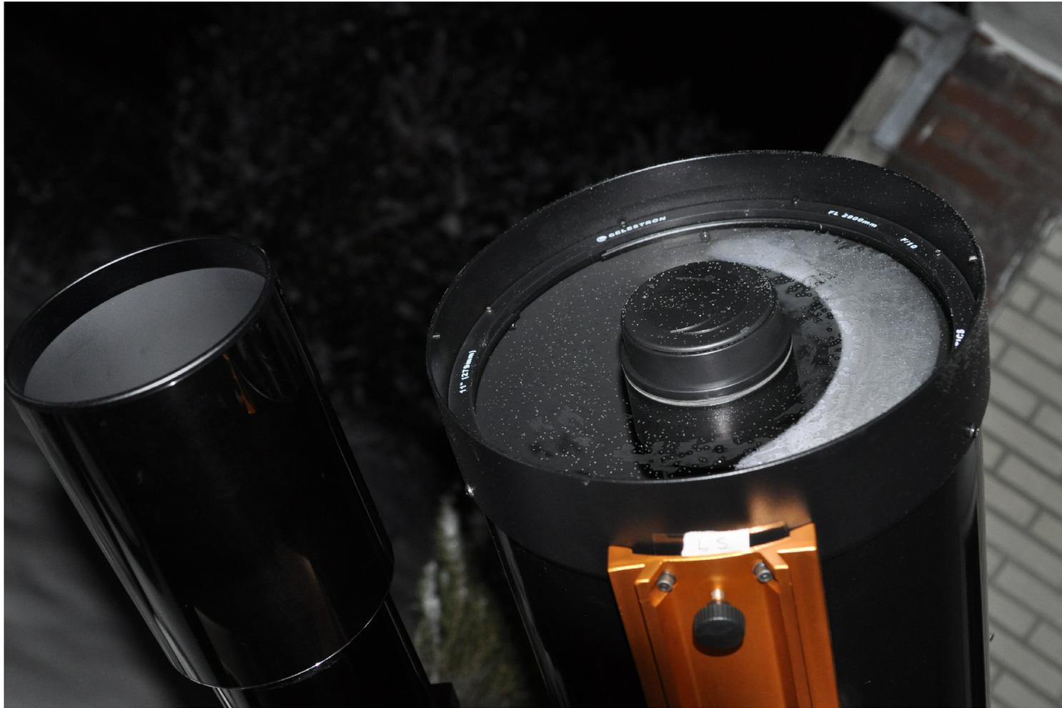
Bild 4. Eingefrorenes Tauwasser auf der Korrekionsplatte des C11's
