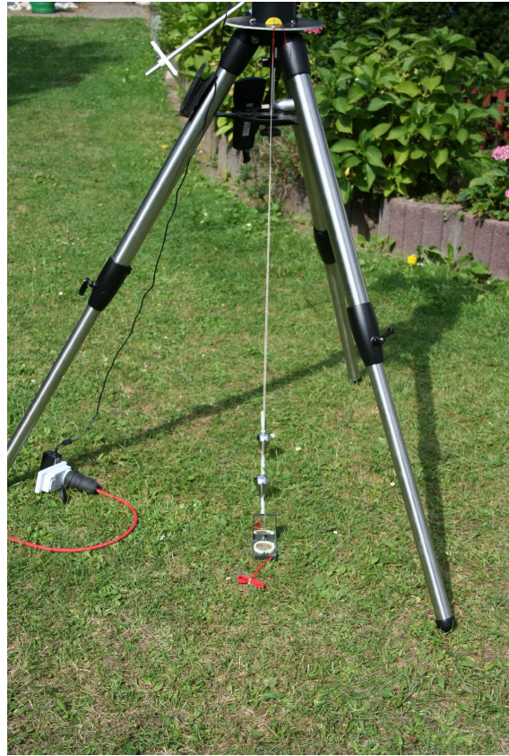
Abb. 2: Nordausrichtung mit Kompass und Loten als Peilhilfe
