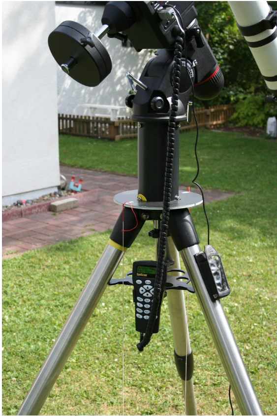
Abb. 1: Kreisring mit aufgesetzter Montierung
