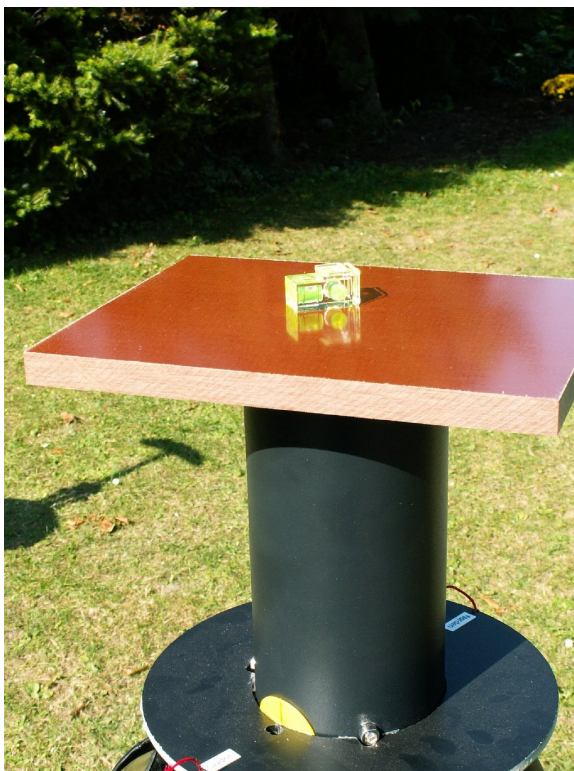
Abb. 3: Waagrechte Ausrichtung mittels gekreuzter Wasserwaage
